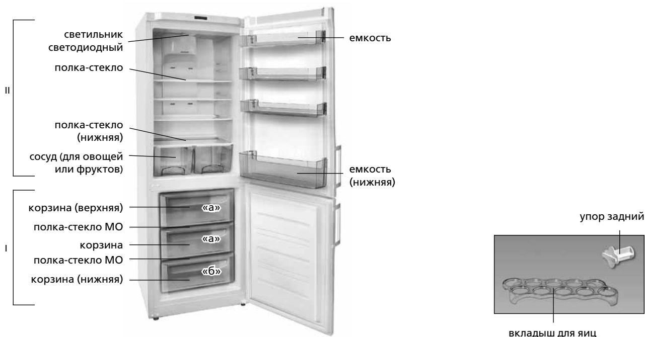
I – морозильное отделение (МО); «а» – зона замораживания и хранения, «б» – зона хранения; II — отделение для хранения свежих пищевых продуктов (ХО)
