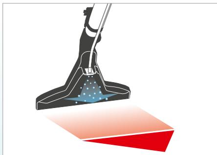
Führen Sie den Waschsaugvorgang durch. Betätigen Sie hierzu den Hebel des Absperrventils am Handgriff und ziehen Sie die Waschsaugdüse von vorne nach hinten über die zu reinigende Fläche.
