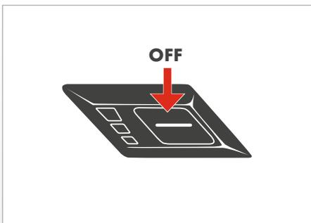
Zum Ausschalten des Gerätes drücken Sie die Starttaste erneut. Beim Wiedereinschalten startet das Gerät in der zuvor gewählten Saugleistungsstufe, sofern es nicht vom Stromnetz getrennt wurde.
