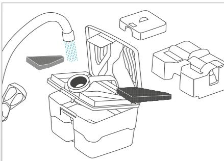
Reinigen Sie alle Bauteile des Aquafilters mit klarem, eventuell warmem Wasser.
