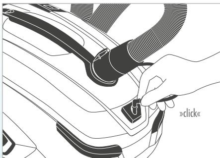
Schließen Sie die Sprühleitung über die Schnellkupplung am Gerät an.
