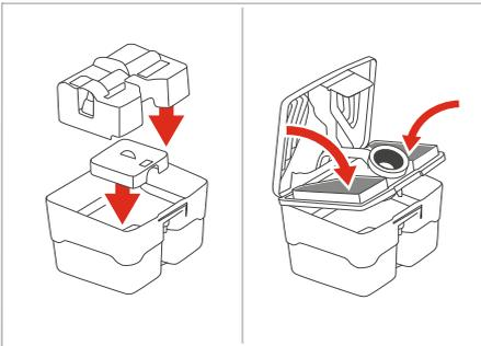
Wurde der Ansaugfilter entnommen, setzen Sie diesen in den Schmutzwasserbehälter ein.
