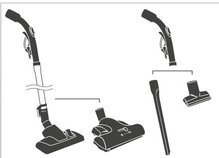
Schließen Sie das Teleskoprohr und/oder die für den gewünschten Anwendungsfall ausgewählte Düse an den Handgriff des Saugschlauches an.
