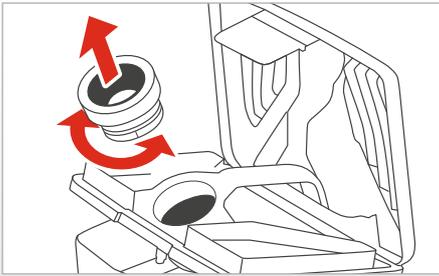
Der Ejektor kann durch Drehen der Stutzendichtung für die Reinigung entnommen werden.
