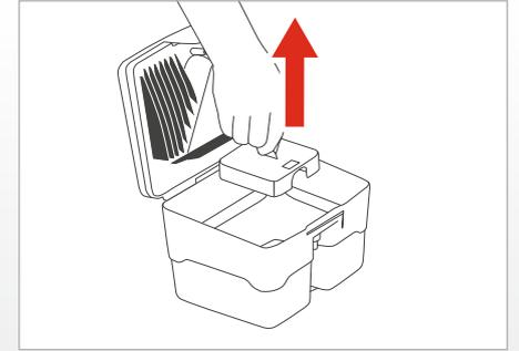
Su filtresinin tüm parçalarını temiz, gerektiğinde sıcak su ile temizleyin.
