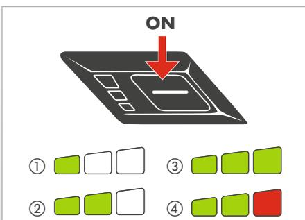
Schalten Sie das Gerät durch kurzzeitiges Drücken der Starttaste ein. Das Gerät startet im Eco-Modus, was durch das Leuchten von zwei grünen Anzeigebalken angezeigt wird.
