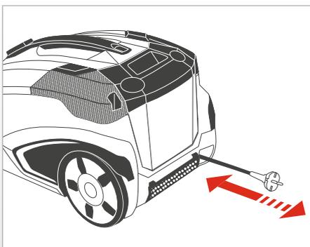
Ziehen Sie den Netzstecker aus der Steckdose. Ziehen Sie das Netzanschlusskabel mit leichtem Zug vom Gerät weg und lassen Sie es los. Das Kabel rollt sich dann automatisch auf.
