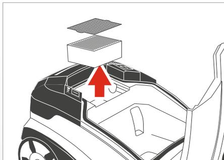
EPA-FILTER und EPA-Vorfilter reinigen
