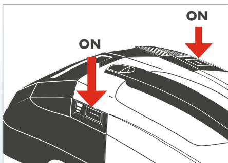
Schalten Sie das Gerät ein und wählen Sie die gewünschte Leistungsstufe. Schalten Sie die Pumpe durch kurzzeitiges Drücken der Pumpentaste ein.
