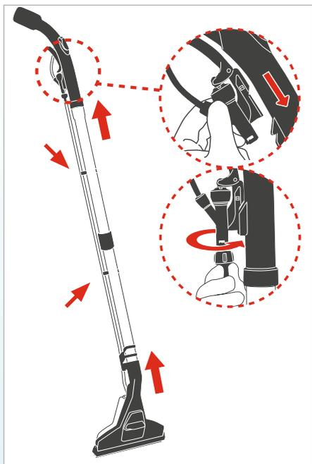
Schließen Sie das Teleskoprohr mit der passenden Seite an den Handgriff des Saugschlauchs und die Waschsaugdüse an das Teleskoprohr an.
