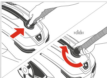
Schließen Sie den Saugschlauch am Gerät an.
